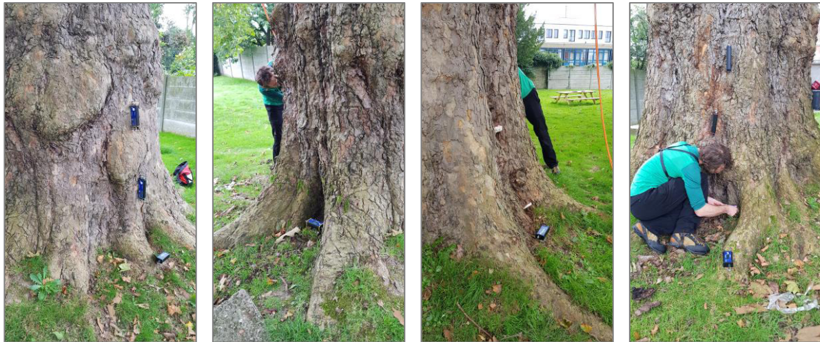
Figure 5. Localisation des 8 sondes (4 élastomètres et 4 inclinomètres) placées sur le platane.
